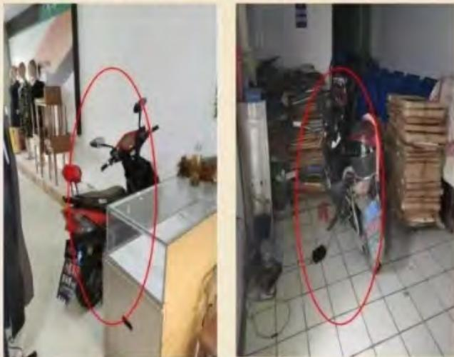
图1电动自行车推进公众聚集场所 图2电动自行车在室内充电
